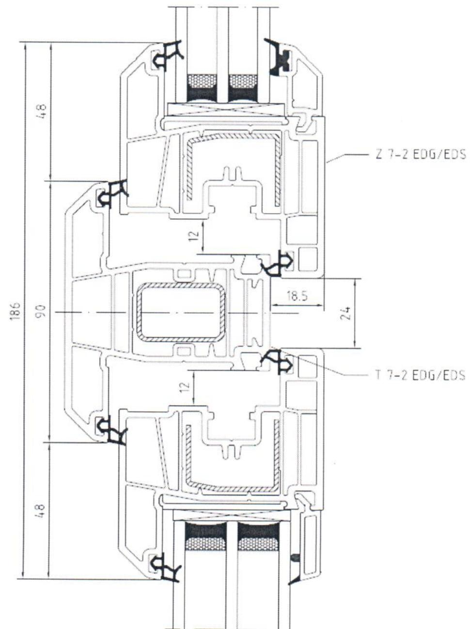
Рис. 24. Сечение главных профилей поливинилхлоридных системы
