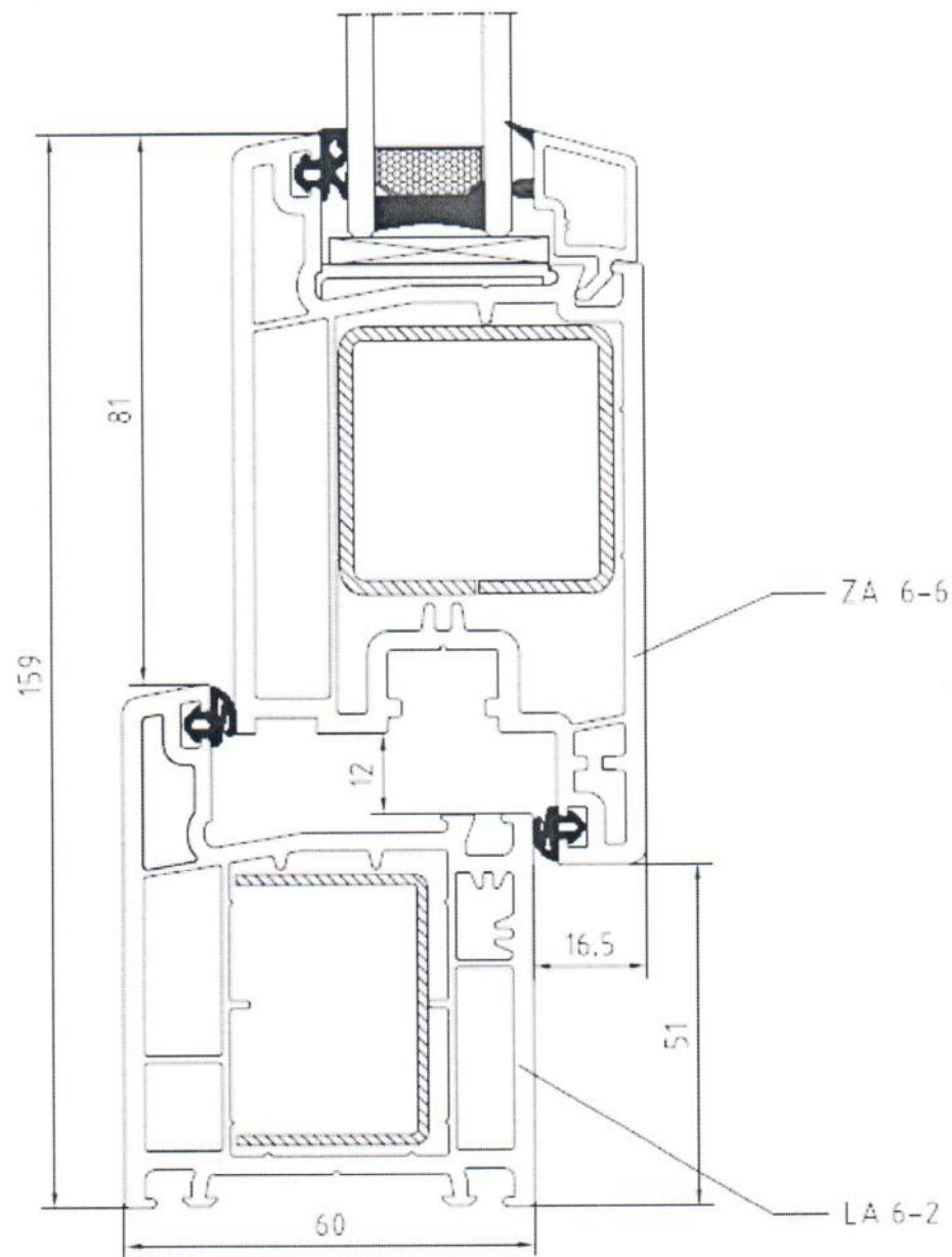
Рис.27. Сечение главных профилей поливинилхлоридных систем ARtec дверной серии "TS 60"
