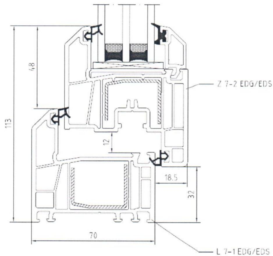
Рис.23. Сечение главных профилей поливинилхлоридных системы
