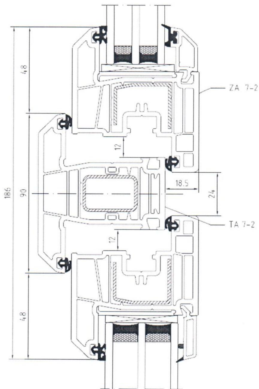
Рис. 15. Сечение главных профилей поливинилхлоридных систем ARtec серии "EFFECTIV"
