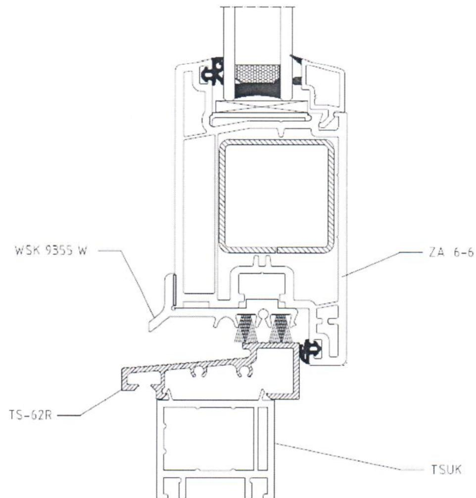
Рис.31. Сечение профилей поливинилхлоридных системы ARtec
