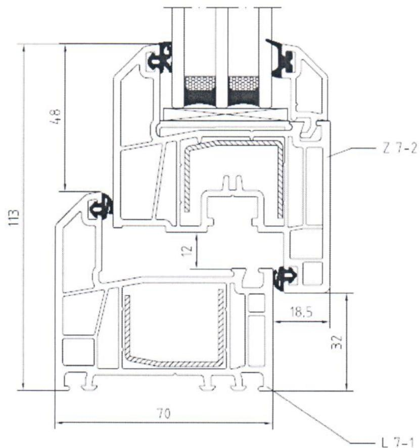
Рис.20. Сечение главных профилей поливинилхлоридных систем ARtec серии "EXTRATHERM"
