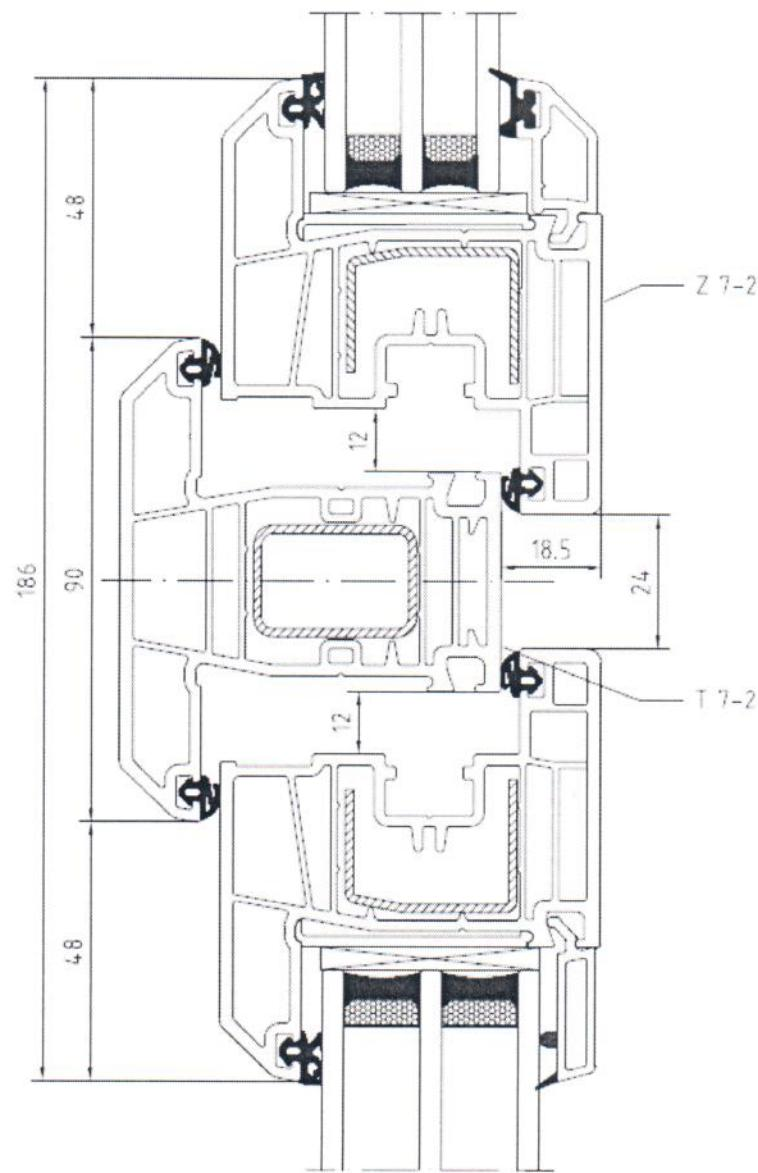
Рис.21. Сечение главных профилей поливинилхлоридных систем ARtec серии "EXTRATHERM"
