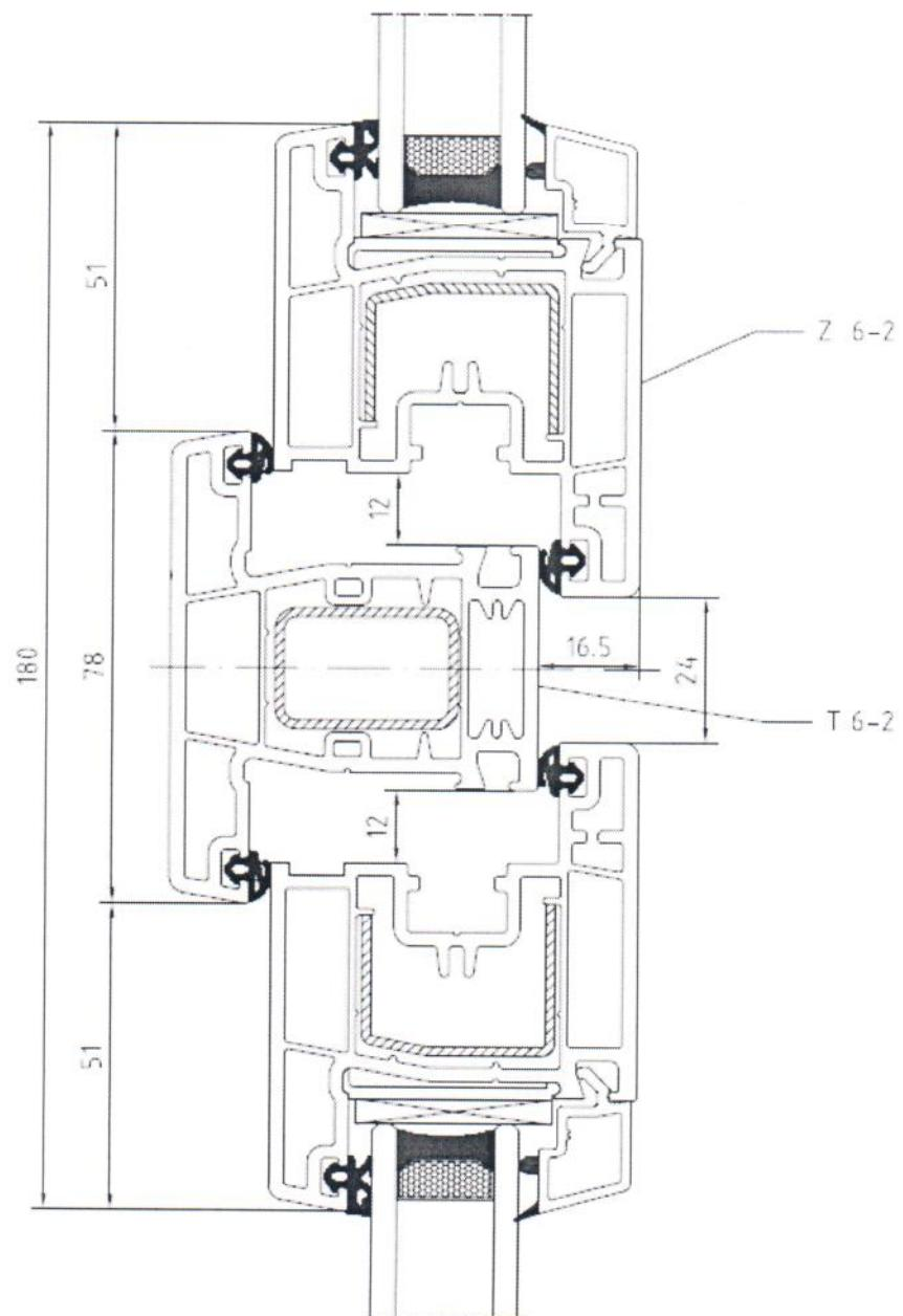
Рис. 3. Сечение главных профилей поливинилхлоридных систем Artec серии "EVOLUTION" (арт. Z 6-2/T 6-2)
