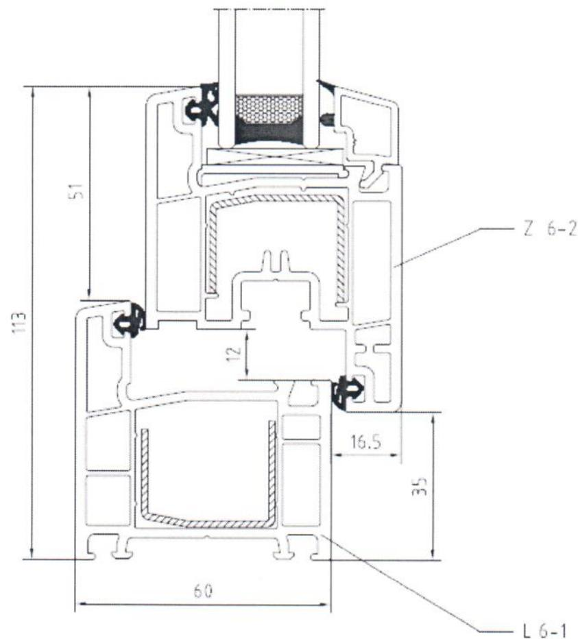
Рис.2. Сечение главных профилей поливинилхлоридных систем ARtec серии "EVOLUTION" (арт. L 6-1/Z 6-2)
