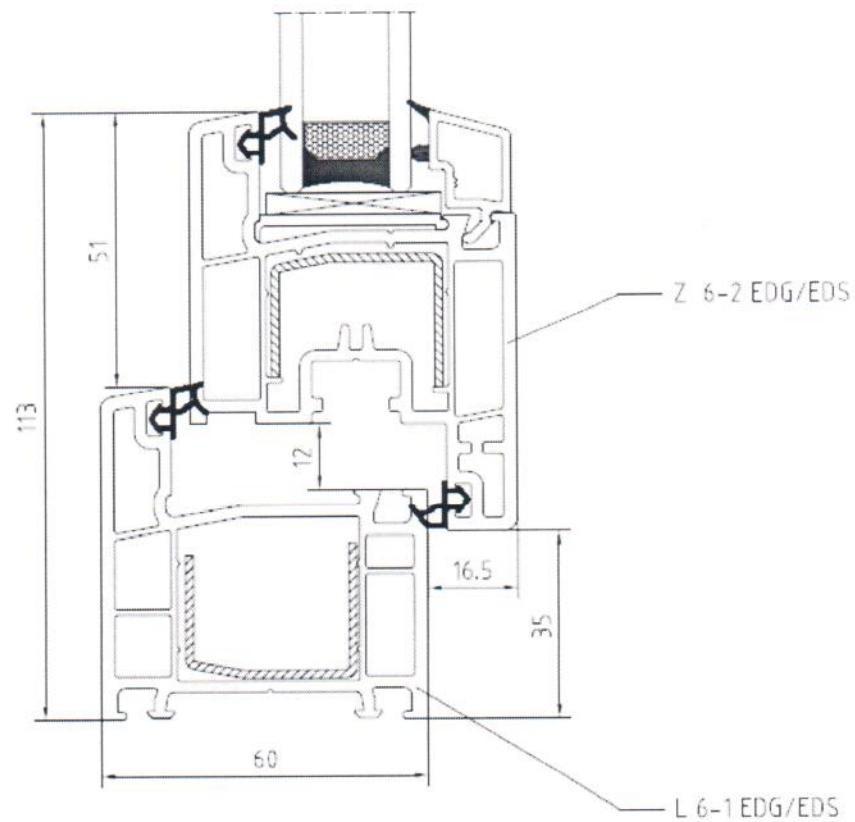
Рис.5. Сечение главных профилей поливинилхлоридных системы ARtec серии "EVOLUTION"
