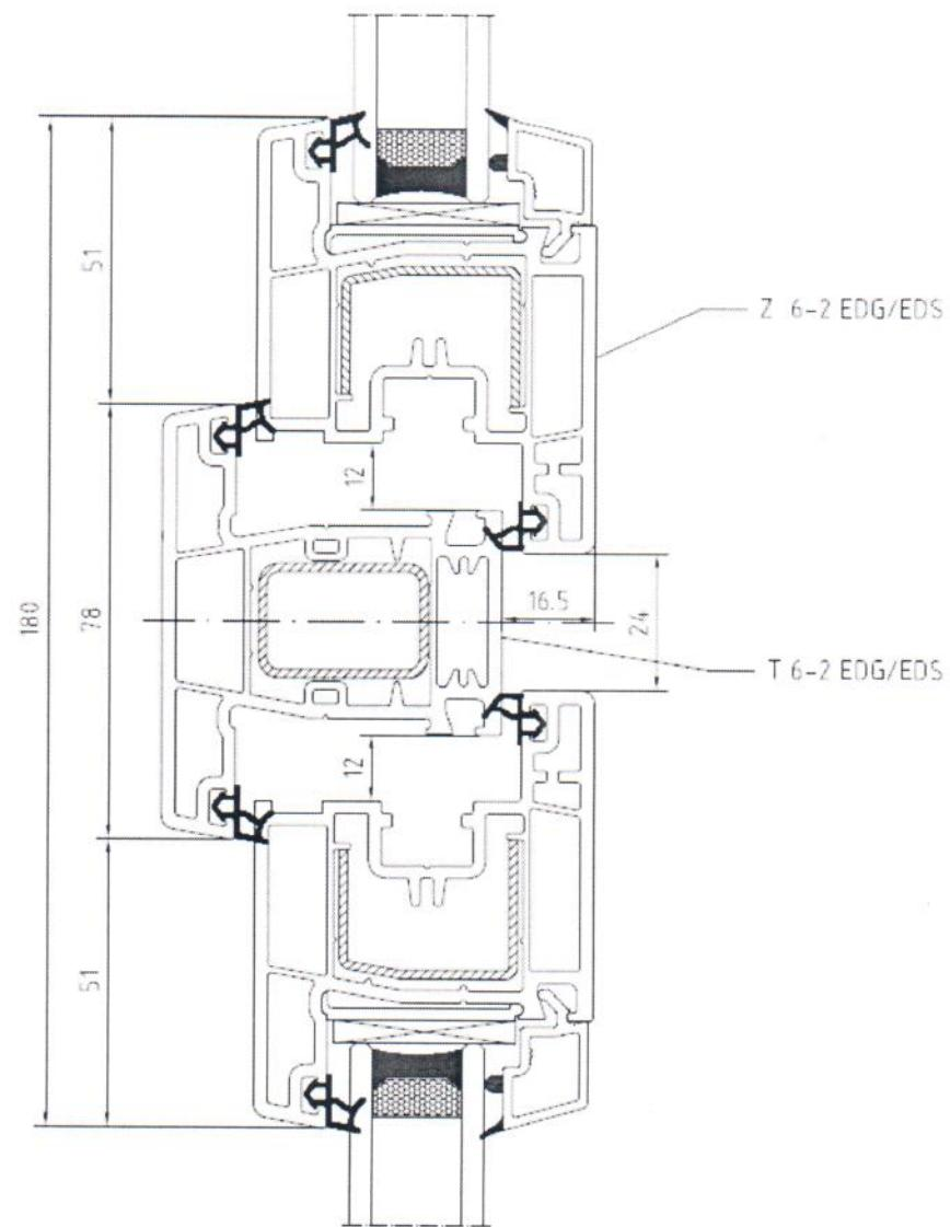
Рис.6. Сечение главных профилей поливинилхлоридных системы ARtec серии "EVOLUTION"
