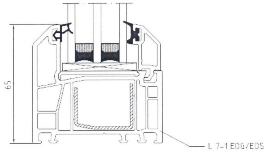
Рис.22. Сечение главных профилей поливинилхлоридных систем ARtec серии "EXTRATHERM"
