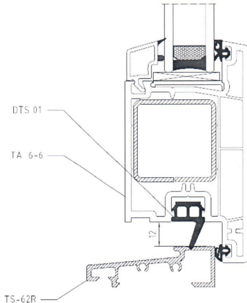
Рис.30. Сечение профилей поливинилхлоридных системы ARtec
