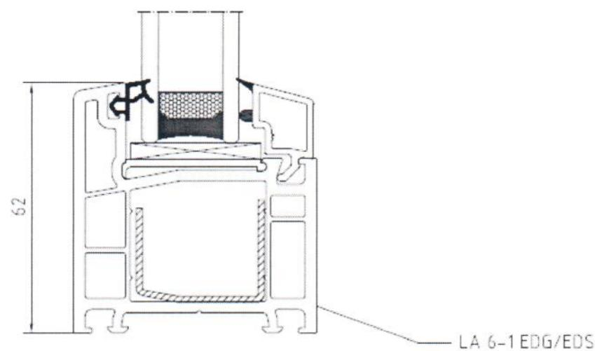
Рис.10. Сечение главных профилей поливинилхлоридных системы ARtec серии "CLASSIC"
