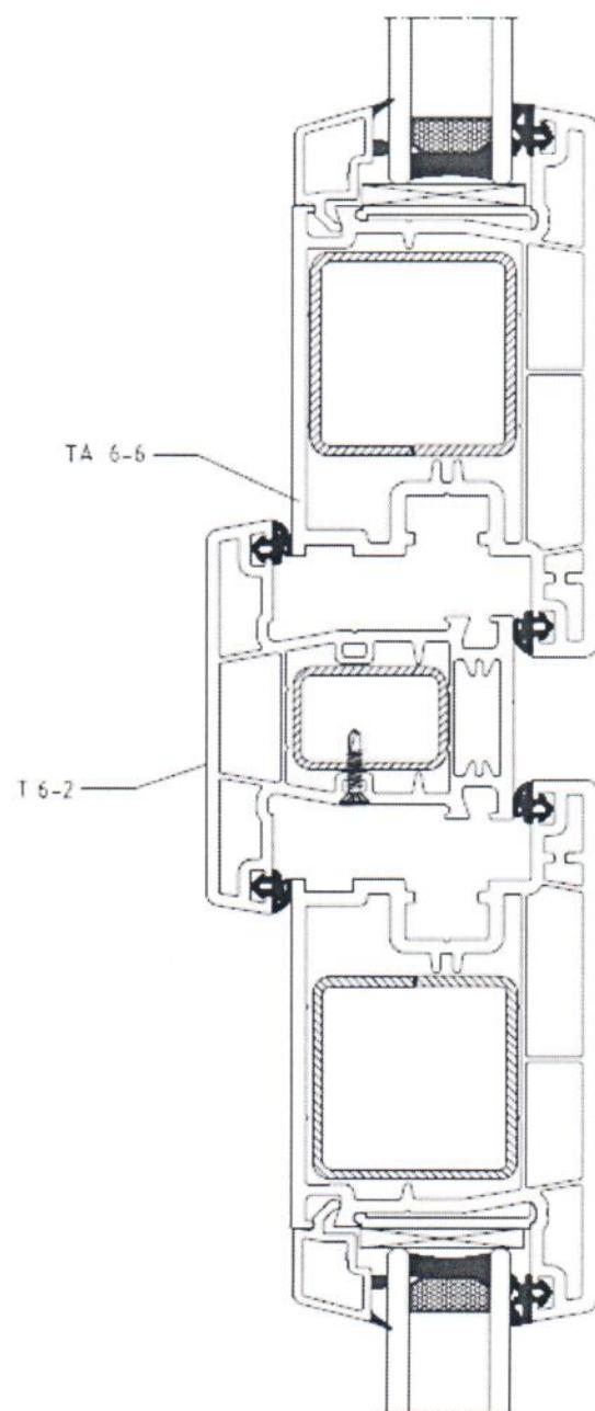
Рис.28. Сечение главных профилей поливинилхлоридных систем ARtec дверной серии "TS 60"
