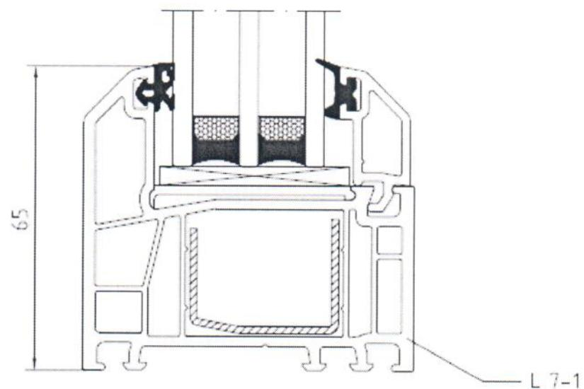
Рис.19. Сечение главных профилей поливинилхлоридных систем ARtec серии "EXTRATHERM"
