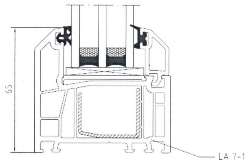
Рис.13. Сечение главных профилей поливинилхлоридных системы ARtec серии "EFFECTIV"
