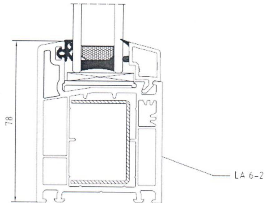
Рис.25. Сечение главных профилей поливинилхлоридных систем ARtec дверной серии "TS 60"
