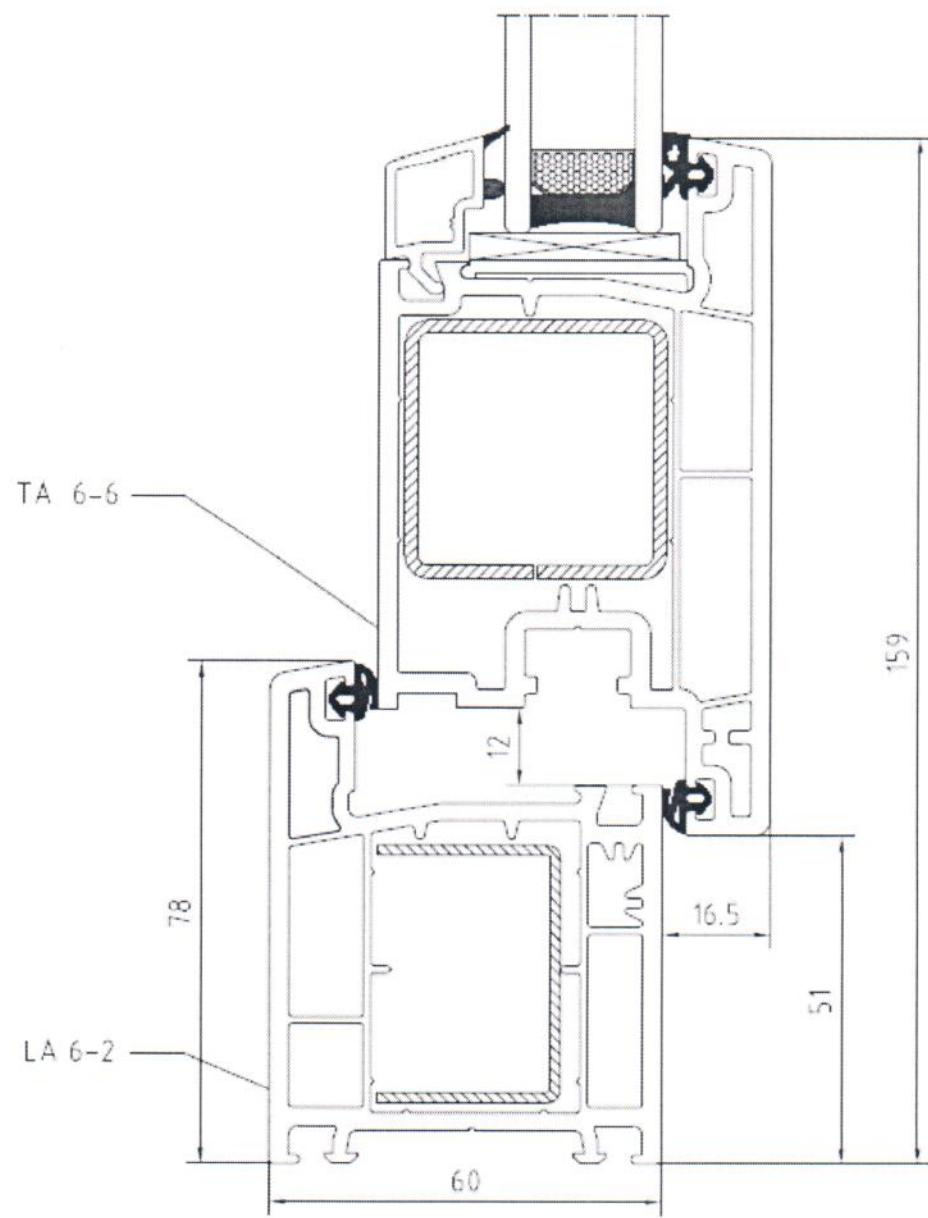
Рис.26. Сечение главных профилей поливинилхлоридных системы ARtec дверной серии "TS 60"
