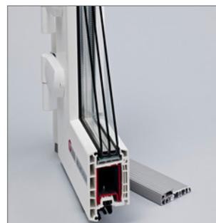
Система дверных профилей REHAU 70 мм сочетает в себе особую элегантность внешнего вида и высокие энергосберегающие показатели. Она выгодно подчеркнет стилевое решение интерьера и защитит дом от потери тепла. Прочность дверей из профилей REHAU 70 мм вне сомнений: четырехкамерный профиль створки с системной глубиной 70 мм и массивное стальное армирование гарантируют высокую стабильность и надёжность конструкции.
