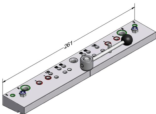
Шаблон для механического соединения
