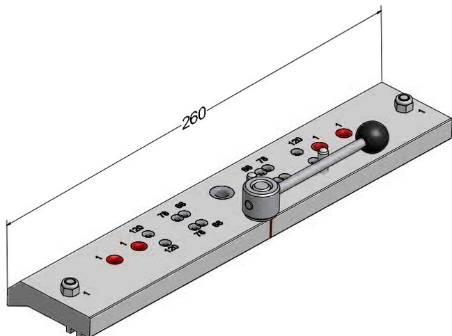
Шаблон для механического соединения
