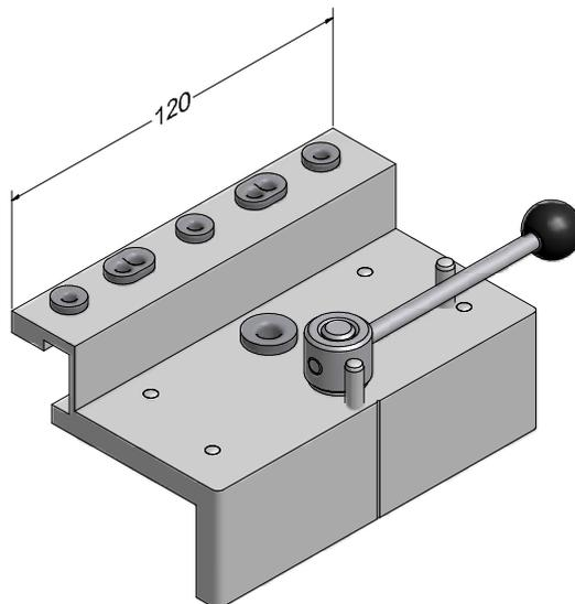
Шаблон для механического соединения,
