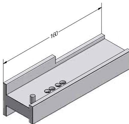
Шаблон для механического соединения горбылька (отв. в горбыльке)
