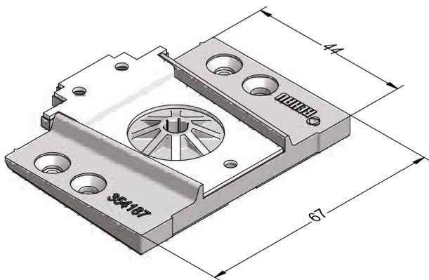
Механический соединитель импоста 78 и коробки,
