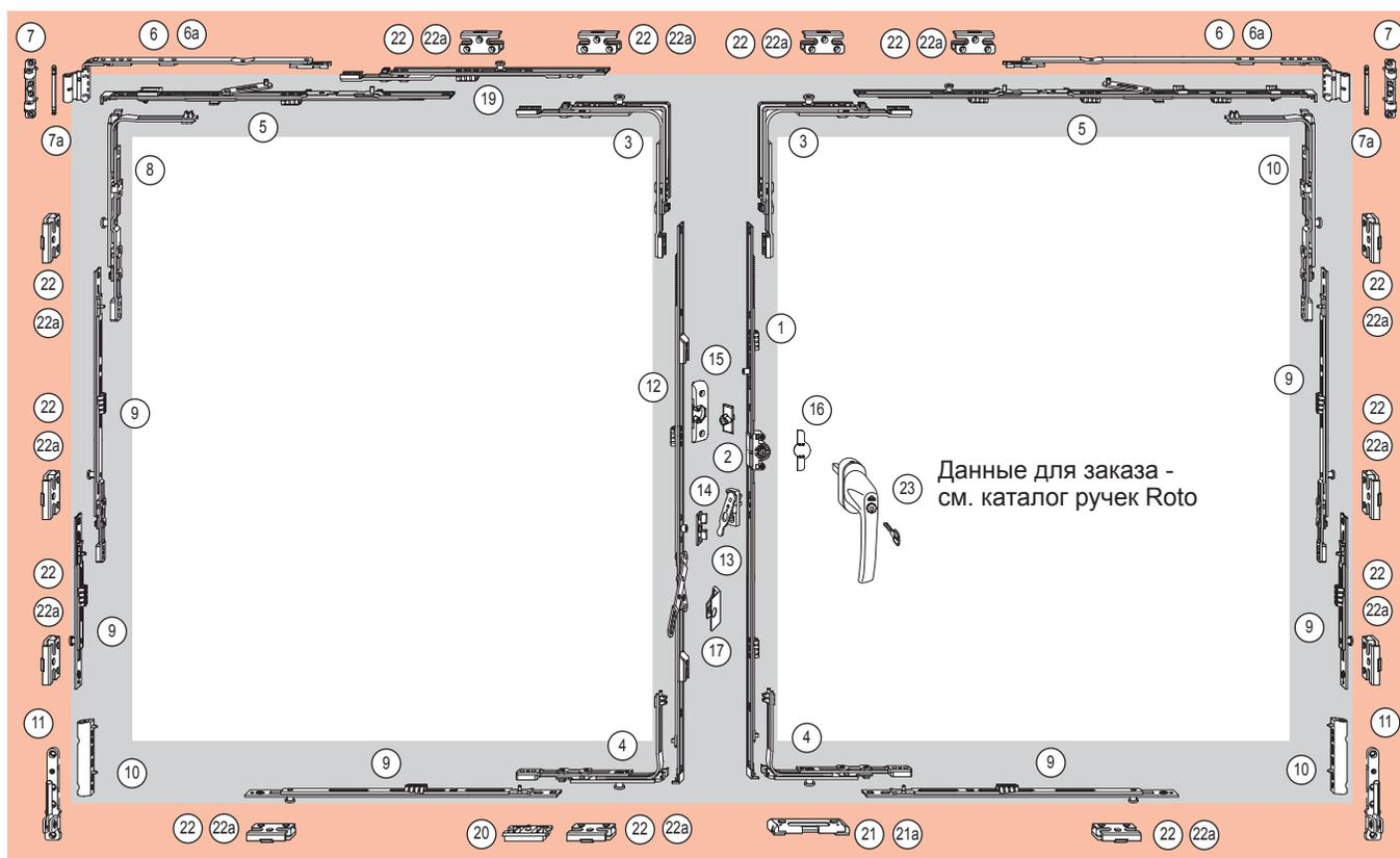
Для ВСФ < 500 мм откидывание ограничить до 80 мм!
