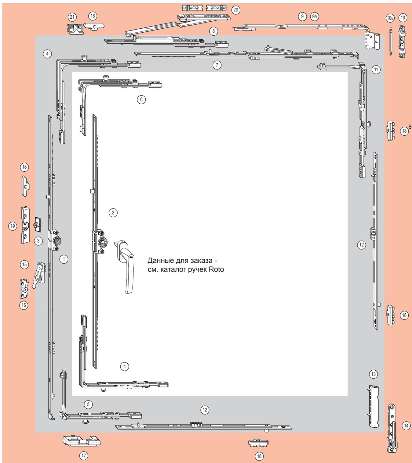
Для ВСФ < 500 мм откидывание ограничить до 80 мм!
