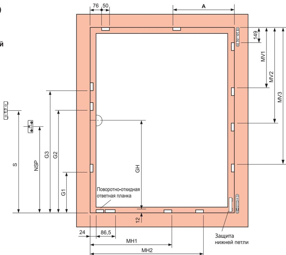
Монтаж ответных планок (в мм)
