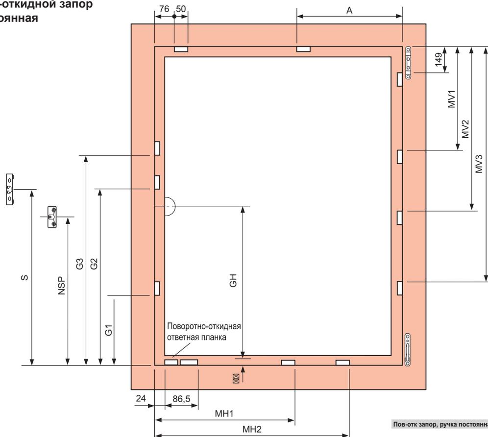
Монтаж ответных планок (в мм)
