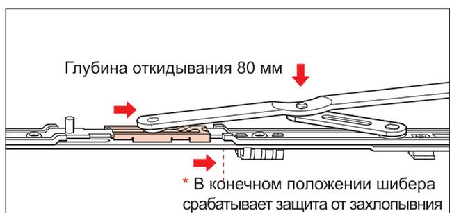
\* Функция защиты от захлопывания включается автоматически при откидывании створки
