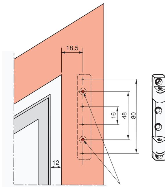
Отверстие Ø 3 мм, глубиной 4 мм
