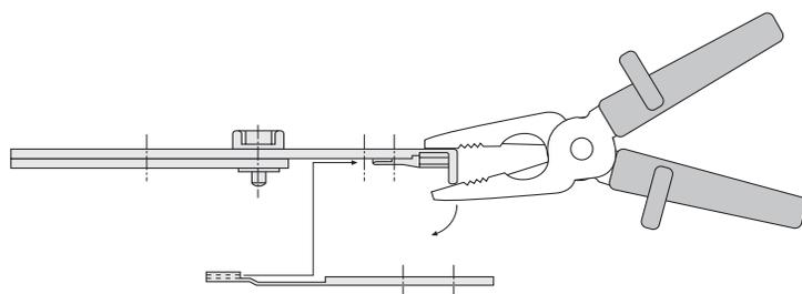
Наконечник **246 734** задвинуть по стрелке и согнуть в зависимости от угла наклона
