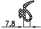
МПУ-64003 (ЭЗУ-215) Профиль резиновый наружный для уплотнения заполнений и организации притвора окон.
