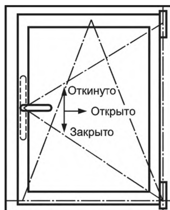
Рисунок Б.3 — Схема поворотно-откидного открывания
